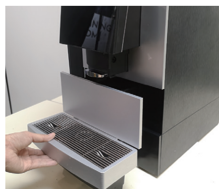
4. Sécher et remettre en place le bac de récupération.
